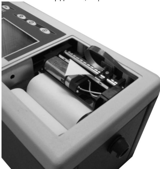
Рис Б.2. Газоанализатор ДААГ-510, замена бумаги в принтере.
